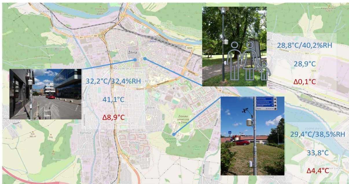
Obrázek 4: Meteostanice a senzory prohřívání povrchu nasazené na lokality v centru (Aupark a Na Studničkách, vlevo) a na lokalitě univerzity obklopené lesy (vpravo), data z 30.7.2022
