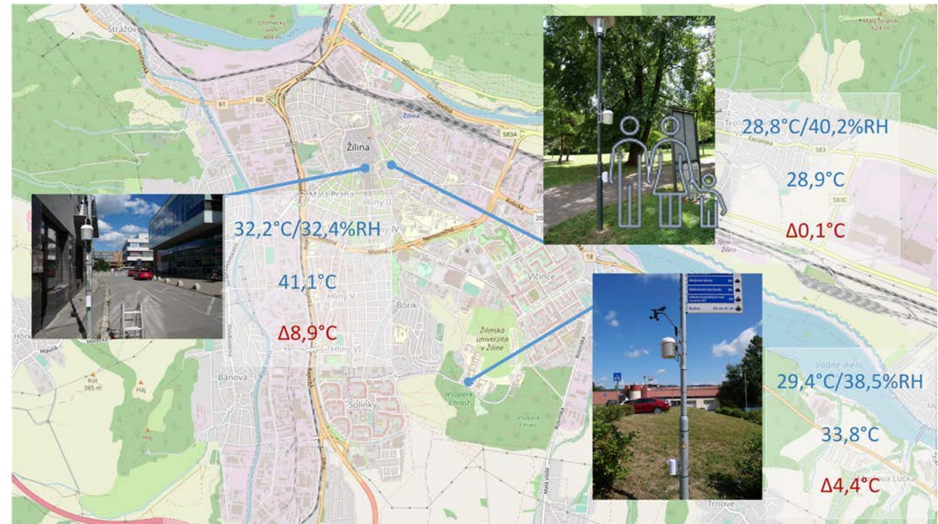
Meteostanice a senzory prohřívání povrchu nasazené na lokality v centru (Aupark a Na Studničkách, vlevo) a na lokalitě univerzity obklopené lesy (vpravo). Jedná se o příklad extrémních hodnot z 30.7.2021 v 16:20.
