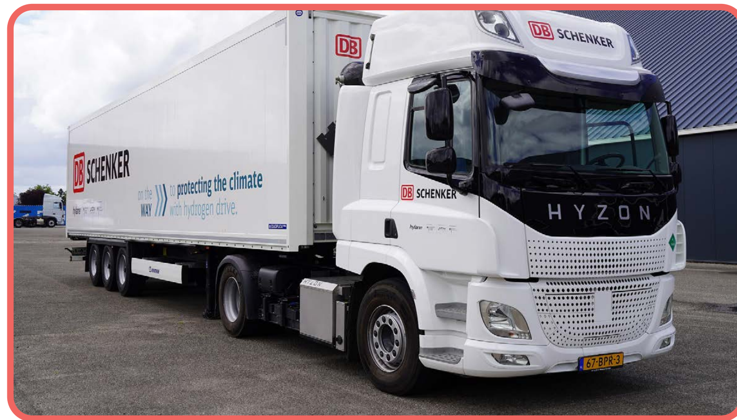
Nákladní vozidla poháněná vodíkovými palivovými články mají v porovnání s vozidly poháněnými bateriemi několik výhod, a to především v dálkové přepravě. Maximální užitečné zatížení je vyšší, dojezd delší a proces tankování srovnatelný s dieslovými modely.
